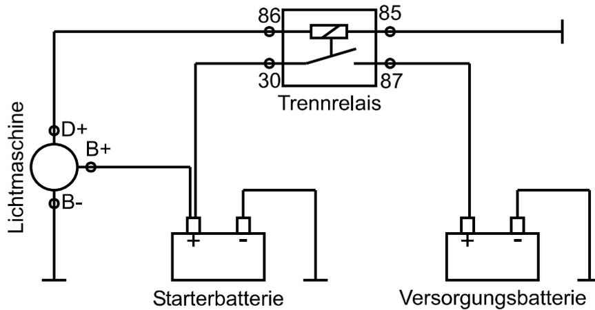
Kabelquerschnitte      Anschluss 85 und 86 min. 1 mm<sup>2</sup>
